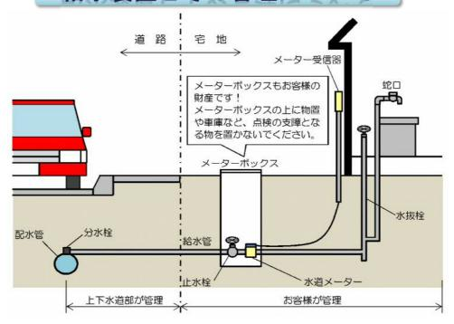
道路に埋設された水道本管(配水管)から分かれて、分水栓から家庭まで引き込まれた水道管、水抜栓、蛇口などを「給水装置」と呼びます。
